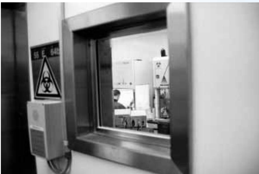
Blick durch ein Sichtfenster in ein Labor der Sicherheitsstufe 3. Das Sichtfenster erlaubt, die Vorgänge im Labor auch von aussen ständig im Aug zu behalten und damit zusätzliche Sicherheit zu gewährleisten. Quelle: FBS
