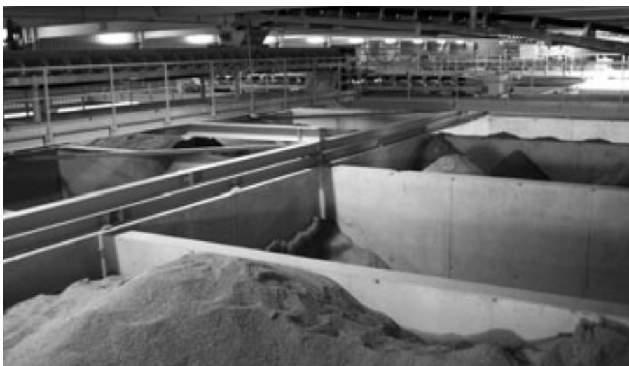
Die Schlacke, die heute auf Deponien abgelagert wird, ist noch nicht von optimaler Qualität. Künftig soll sie chemisch stabiler sein und weniger Metalle enthalten.
