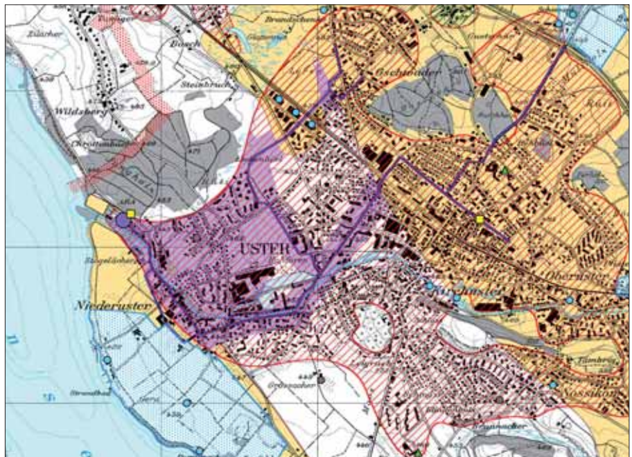
Die meisten Gemeinden mit mehr als 5000 Einwohnern verfügen über Potenzial zur Energienutzung aus Abwasser. Die kommunale Energieplanung ist ein wichtiges Umsetzungsinstrument dazu. Im Bild der Energieplan der Stadt Uster: Violett eingezeichnet das «Prioritätsgebiet für Wärmenutzung aus Abwasser» entlang von Hauptsammelkanälen (blau) und in der Umgebung der Kläranlage. Rot schraffiert das Gasversorgungsgebiet, wo Wärmepumpen mit Blockheizkraftwerken kombiniert werden können.
