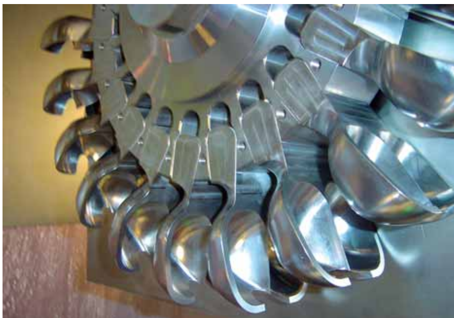
In Fällanden wird der Druckunterschied zwischen zwei Reservoirs mit Hilfe des Laufrads einer Gegendruck-Pumpturbine zur Stromproduktion genutzt.
