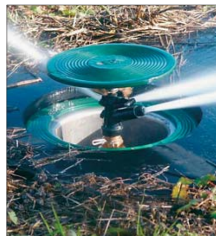
Versenkbarer Regner, Regnerkopf ausgefahren und in Betrieb.
