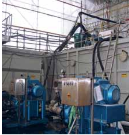
Nach Absiebung der Grobstoffe wurden unter Zugabe von Chemikalien feste und flüssige Stoffe voneinander getrennt und in Membrankammerfilterpressen entwässert. Die Filterkuchen wurden in Bremen in einer Hochtemperaturverbrennungsanlage entsorgt.
