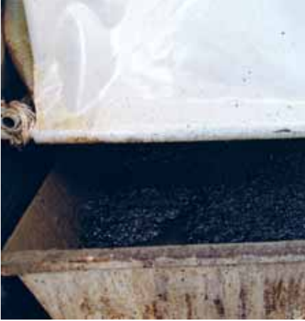
Nach Absiebung der Grobstoffe wurden unter Zugabe von Chemikalien feste und flüssige Stoffe voneinander getrennt und in Membrankammerfilterpressen entwässert. Die Filterkuchen wurden in Bremen in einer Hochtemperaturverbrennungsanlage entsorgt.
