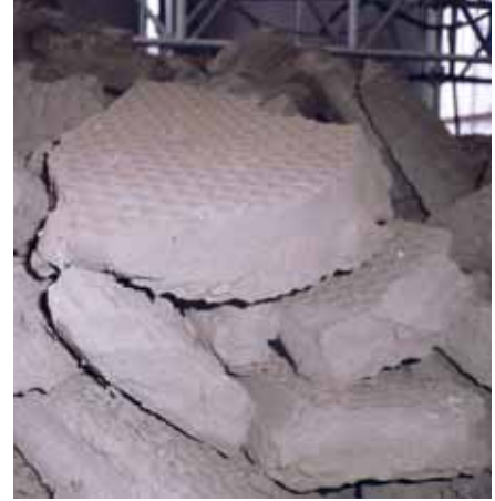
Nach Absiebung der Grobstoffe wurden unter Zugabe von Chemikalien feste und flüssige Stoffe voneinander getrennt und in Membrankammerfilterpressen entwässert. Die Filterkuchen wurden in Bremen in einer Hochtemperaturverbrennungsanlage entsorgt.
