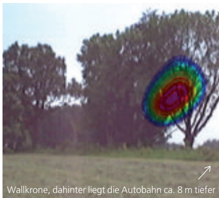
Momentaufnahme aus dem Pegelverlauf der Reflexionen an Bäumen infolge Schussabgabe am strassenseitigen Wallfuss.
