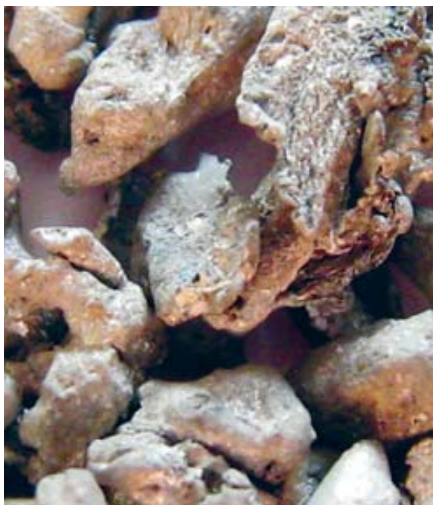
Aluminium-Nuggets gewonnen aus KVA-Schlacke (Fraktion <0.5mm).
