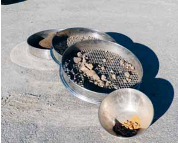
Probenvorbereitung: Sieben des Materials zur Bestimmung des Bleigehalts im Feinanteil.
