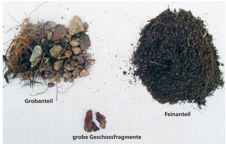
Probenvorbereitung: Sieben des Materials zur Bestimmung des Bleigehalts im Feinanteil.
