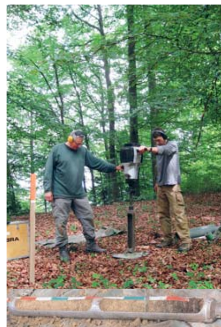
Rammkernbohrung zur Ermittlung der Bodeneigenschaften. Im Vordergrund ein entsprechender Bohrkern.
