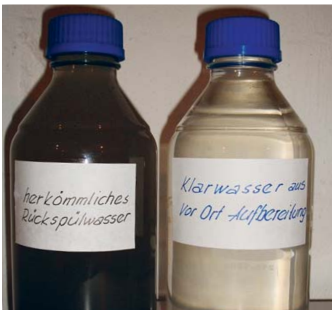
In den Schacht zurückgespültes Abwasser nach dem herkömmlichen Verfahren (links) enthält noch viel mehr partikelgebundene Schadstoffe als nach dem neuen Verfahren mobil vorbehandeltes Abwasser (rechts).
