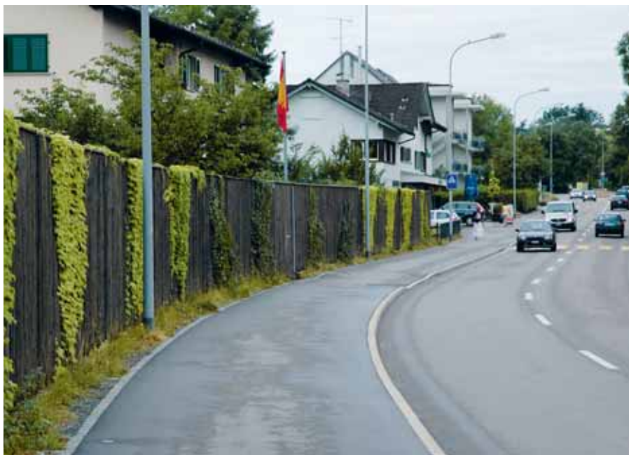
Lärmschutzwände bilden Strassenschluchten und animieren eher zu lärmigem Fahren, Reflexionen an Dachkanten und Traufen der dahinter liegenden Gebäude reduzieren ausserdem die Wirkung von Lärmschutzwänden.
