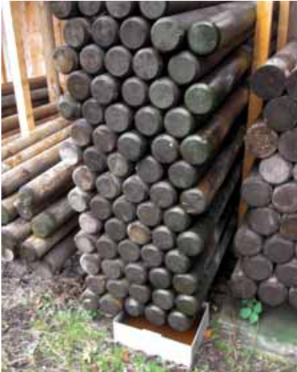
Sammelbecken zur Probenahme unter einem Stapel mit imprägniertem Holz.
