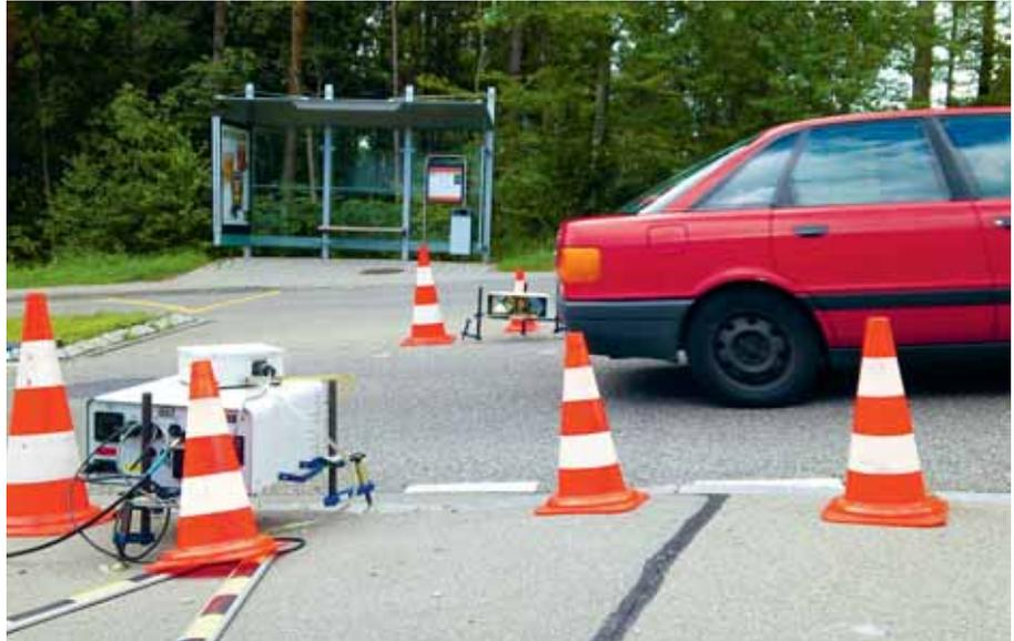
**Berührungslose Abgasmessungen beim vorbeifahrenden Auto per RSD (Remote Sensing Detector) in der Garage.**
