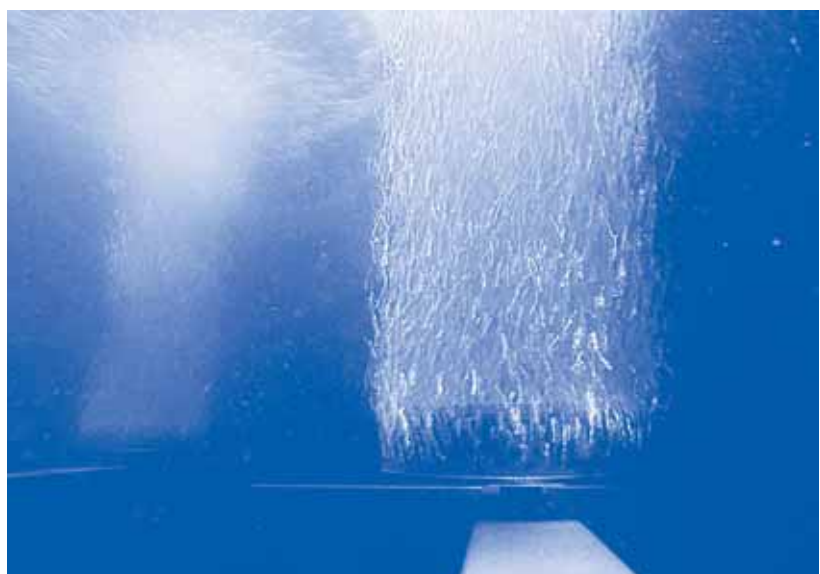
Symbolbild eines Diffusors, mit dem das Ozon in das Wasser eingetragen wird. Quelle: ARA Neugut
