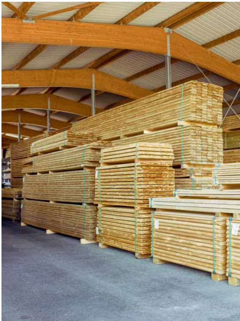
Lagerung von imprägniertem Holz unter Dach. Quelle: Lignum
