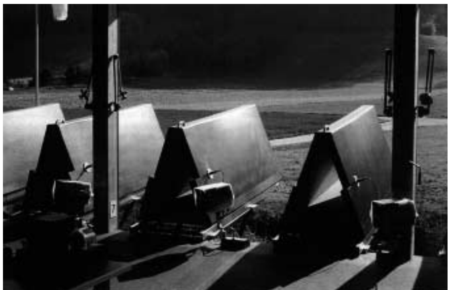
Schiesstunnels zur Reduktion des Mündungsknalls
