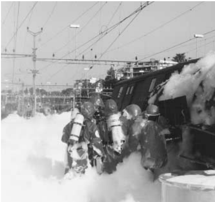
Umfüllen beschädigter Kesselwagen und Abdecken mit Schaum
