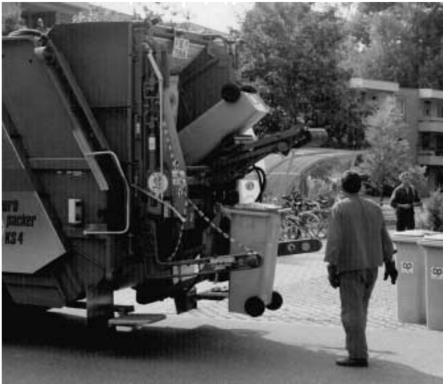
Automatische Hebung und Leerung sowie die Gewichtserfassung erfolgen in einem Arbeitsgang.
