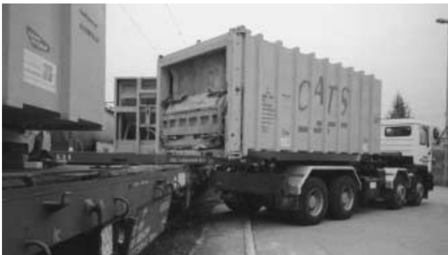
Bei Abroll-Container-Systemen (ACTS) kann der Chauffeur den Umlad des Containers von seinem LKW auf den Güterwagen ohne fremde Hilfe und ohne grosse Investitionen selbst vornehmen. Bild: CATS
