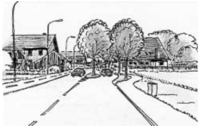
Abb. 1: Mit Mittelinseln kann erreicht werden, dass der ins Dorf hineinfahrende Verkehr seine Geschwindigkeit bereits am Dorfrand den engen und lärmempfindlichen Innerortsverhältnissen anpasst. Wichtig für eine erfolgreiche Lärmreduktion ist ein regelmässiger Geschwindigkeitsverlauf auf tiefem Niveau. (Foto EBP, Zollikon)
