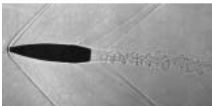
Abb. 1: Schlierenaufnahme eines mit Überschallgeschwindigkeit fliegenden Gewehrscusses. Deutlich sind Kopf- und Schwanzwelle erkennbar. (Foto: EMPA)
