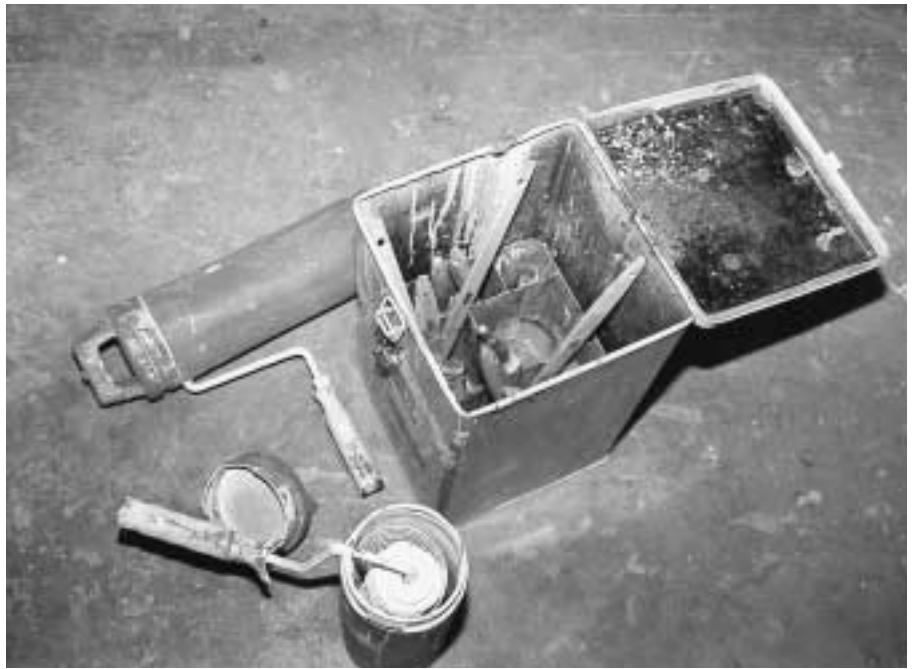
Wer Pinsel und Roller in Boxen oder alten Farbkübeln «übernachten» lässt, senkt den Wasserverbrauch auf einen Zehntel (!) und die Lösemittel-Verluste ebenfalls markant. Zertifizierte Betriebe arbeiten vermehrt mit diesen Hilfsmitteln.
