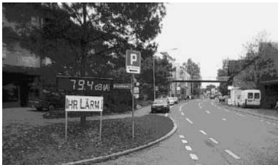
Lärmesstrecke: Eine digitale Grossanzeige zeigt den Vorbeifahrenden den Lärmpegel, für den sie direkt mitverantwortlich sind.
