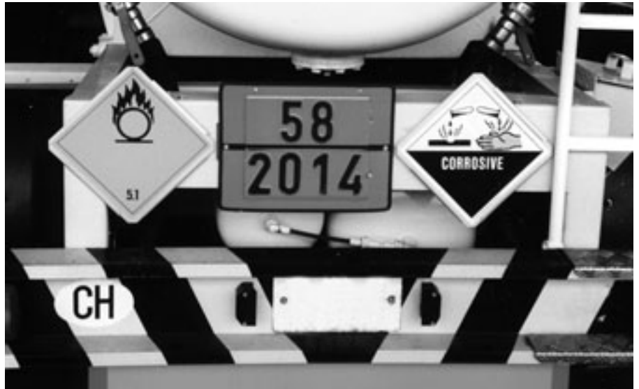
Das Europäische Übereinkommen über die internationale Beförderung gefährlicher Güter auf der Strasse ADR schreibt die Kennzeichnung der Transportfahrzeuge vor.
