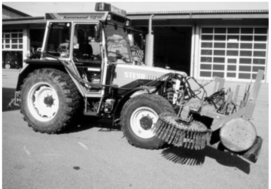
Jätbesen erlauben eine direkte Bekämpfung von Pflanzen am Strassenrand, wo sie nicht toleriert werden können.
