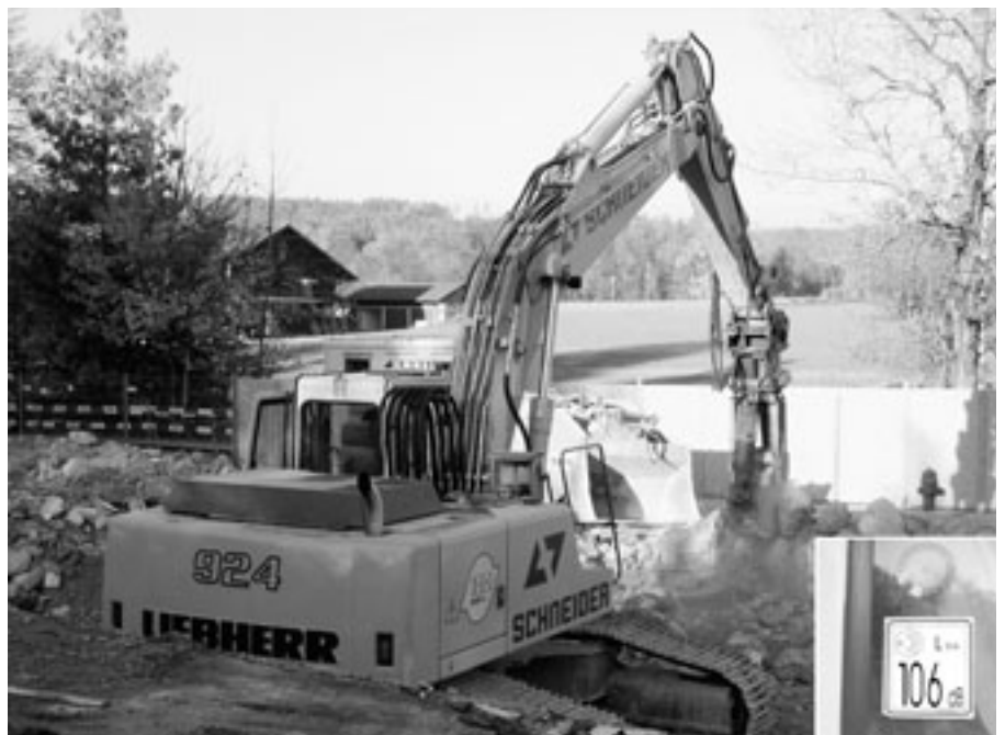
In Zukunft werden auch in der Schweiz immer mehr Baumaschinen mit dem vom Hersteller garantierten Schalleistungspegel plakettiert sein. Quelle: Stefanie Rüttener
