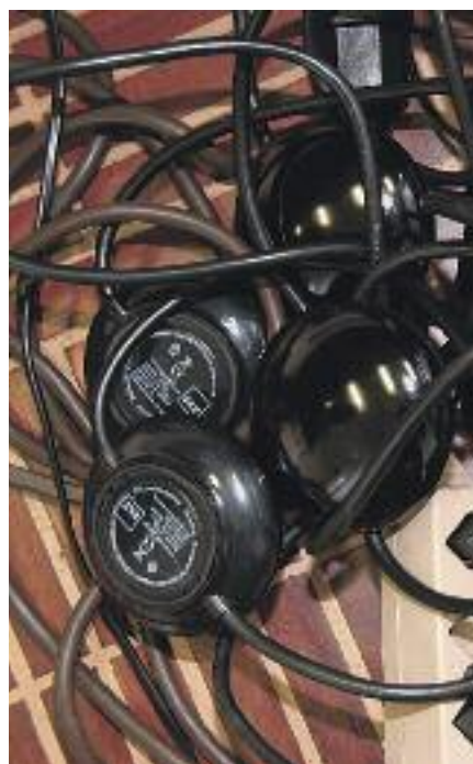
Hilfsmittel wie Stromsparmäuse schalten Geräte auch wirklich ab und verhindern so unnötigen Stromverbrauch. Hier vorgeführt an der «energyweek» 2008.
