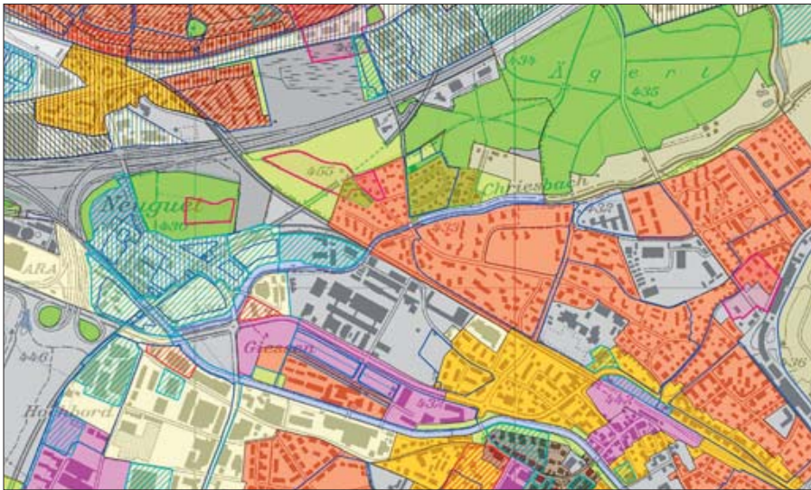
Der GIS-Browser lässt für eine künftige Wohnung erkennen, ob sie beispielsweise in der Zentrumszone (pink) liegt, an eine Industrie- und Gewerbezone (gelb) oder Zone öffentlicher Bauten (grau) grenzt, oder in der Nähe der Landwirtschaftszone (oliv), Freihalte- und Erholungszone (hellgrün) oder Wald (dunkelgrün) liegt.
