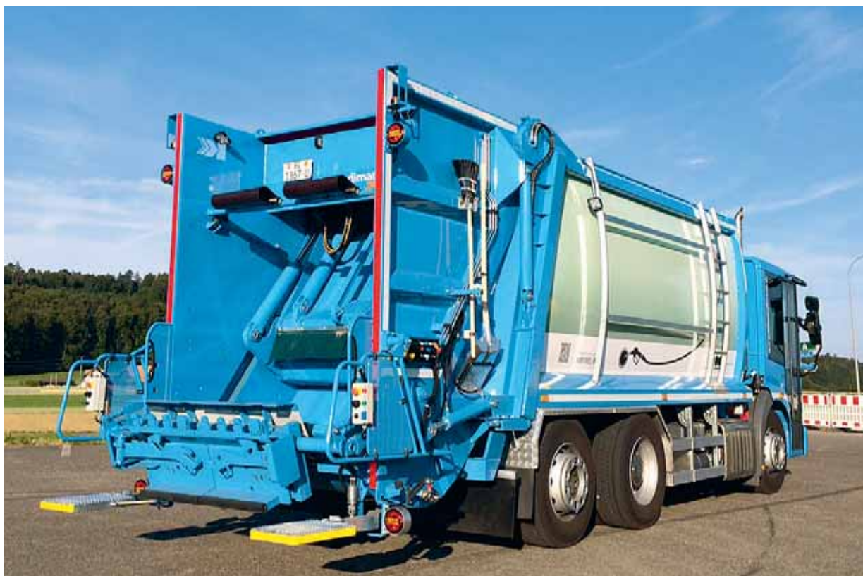
Dank Akku-Paket sammelt der Kehrichtwagen der Schwendimann AG Kehricht leise und effizient. Die Einsparungen an fossiler Energie kompensieren die Mehrkosten für den Akku.
