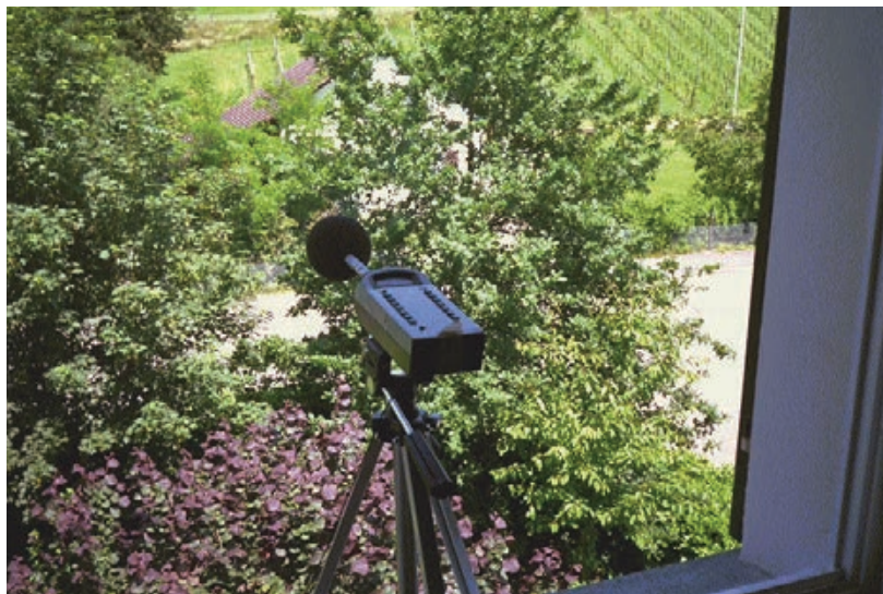
Die Grenzwerte der Lärmschutzverordnung müssen gemäss Bundesgericht in der Mitte jedes offenen Fensters eines Wohnraumes eingehalten werden. Quelle: Fachstelle Lärmschutz
