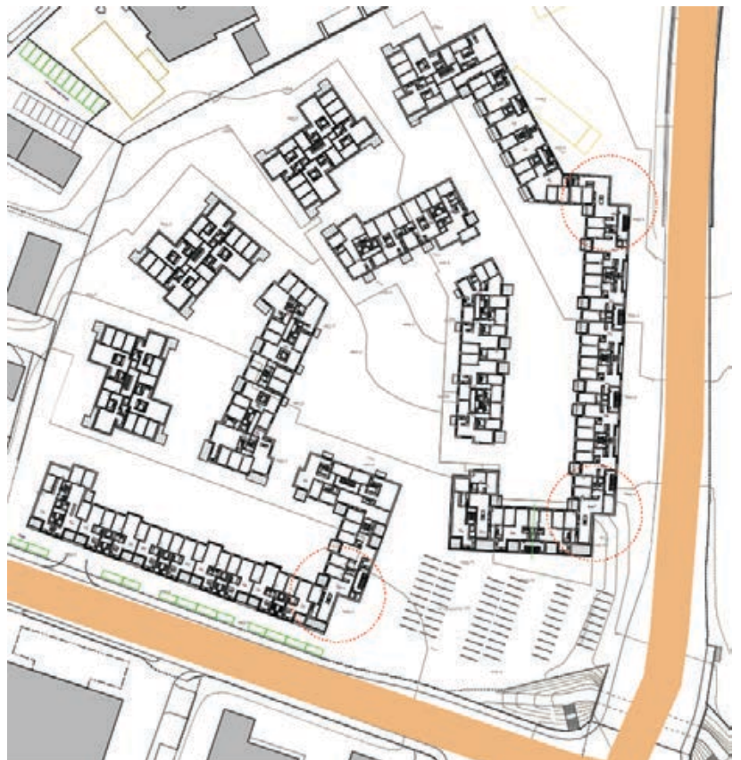
Eine lärmoptimierte Stellung der Gebäude und schmale Baukörper für durchgehende Räume sind primäre Massnahmen für neue Wohnbauten im Lärm. Quelle: Fachstelle Lärmschutz
